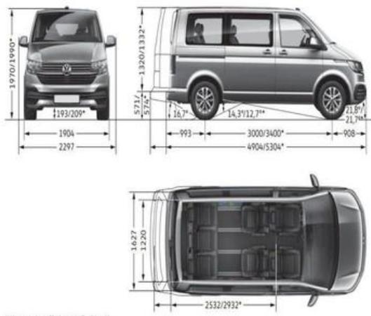
\*Misure sul telaio. Per le versioni DSG e DSG4Motion.
